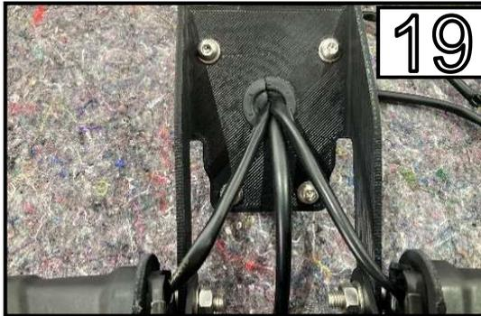
Schneiden Sie den Gummi auf einer Seite auf und führen Sie die 3 Kabel durch den Bike Adapter und Grundplatte.
