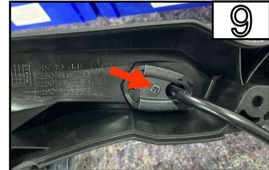
Öffnen Sie die Schraube und entfernen Sie den Sicherheitsbügel.
