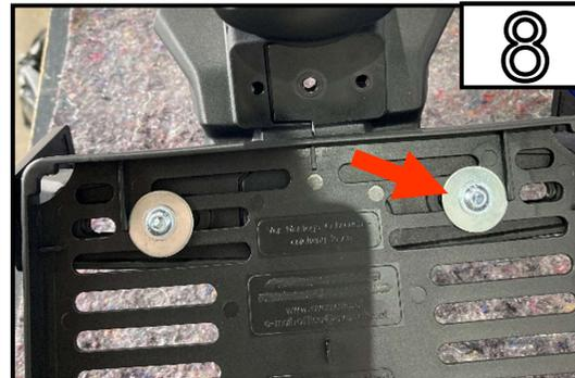
Entfernen Sie die Kennzeichenhalterung und teilen Sie die beiden Hälften des Kennzeichenhalters.
