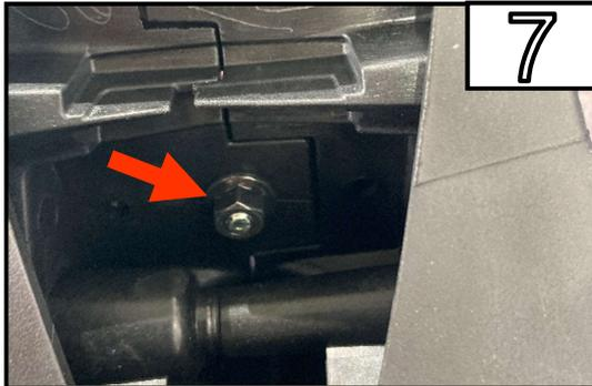
Entfernen Sie die Mutter danach können Sie den Reflektor entfernen.
