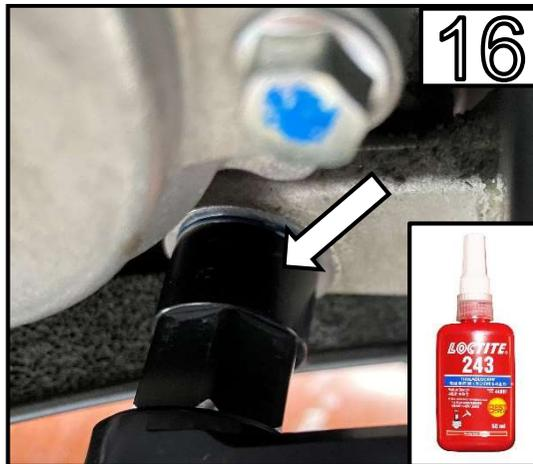
Montieren Sie nun die Distanzadapter für den Schalthebel. Verwenden Sie hier wieder eine Schraubensicherung! /
