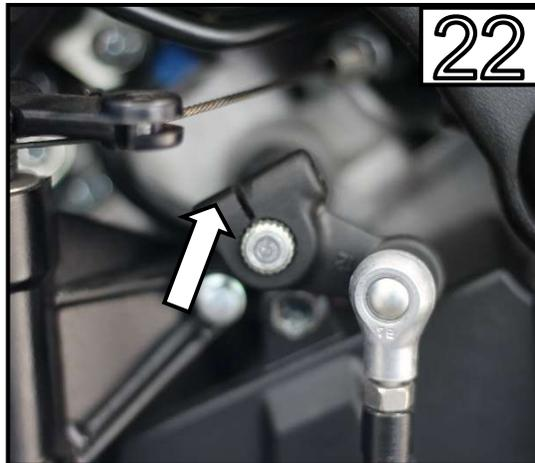
Schieben Sie das Schaltgestänge (um 180°
