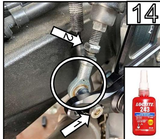
Als nächstes montieren Sie das Kugelgelenk an der Bremspumpe und befestigen Sie das Gelenk mit der Anlage durch den Einsatz der mitgelieferten Schraube (1) und Distanzhülse (laut Übersicht), hier auch Schraubensicherung anwenden! Nach richtiger Einstellung, sichern sie dieses mit der Kontermutter (2).
