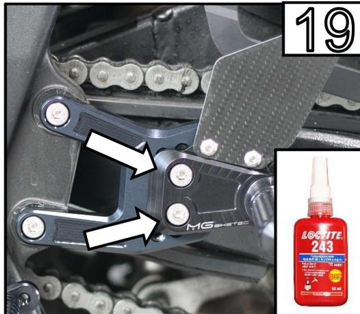
Durch lösen dieser beiden Schrauben können Sie die Position der Fußrastenanlage einstellen. Achten Sie hier nach Findung der perfekten Einstellung, auch hier wieder Schraubensicherung zu verwenden! /
