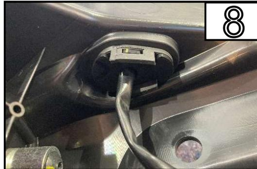
Entfernen Sie die Sicherungsplatte des Blinkers
