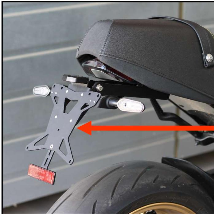
**DE: ACHTUNG:** Montieren Sie nur Ihr Nummerntafel – verwenden Sie keine zusätzliche Stahl- oder Aluminium-Trägerplatte – dies kann zu Bruchschäden an der Halterung führen!!
