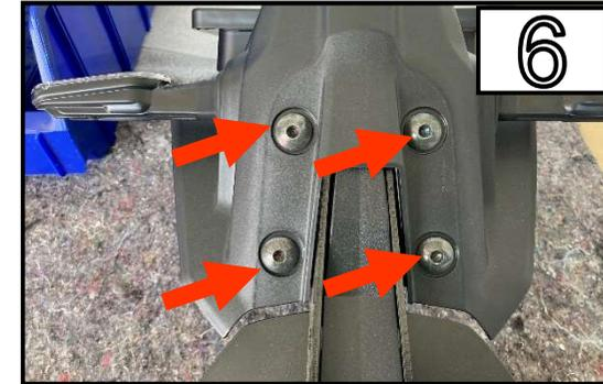
Entfernen Sie die Schrauben
