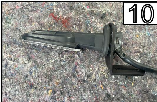
Führen Sie den Blinker in die Halterung
