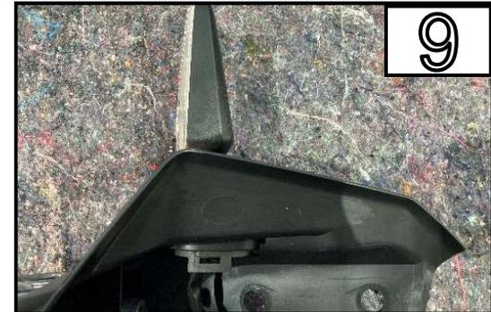
Entfernen Sie den Blinker vom Kennzeichenträger
