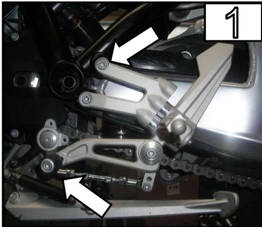
Originale Fußrastenanlage mit Schalthebel und Schaltstange auf der linken Seite demontieren.
