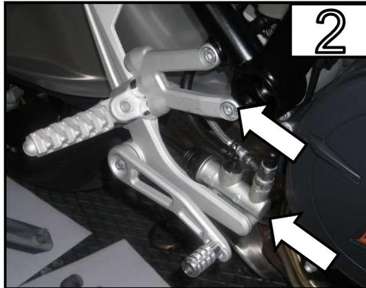
Originale Fußrastenanlage auf der rechten Seite demontieren. Danach die Schrauben der Bremspumpe lösen.
