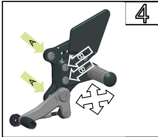
Linke Fußrastenadapterplatte mit Trägerplatte am Rahmen mit den Schrauben montieren. (A)
