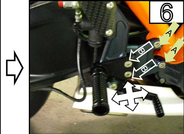
Rechte Fußrastenadapterplatte mit Trägerplatte am Rahmen mit den Schrauben montieren (A).
