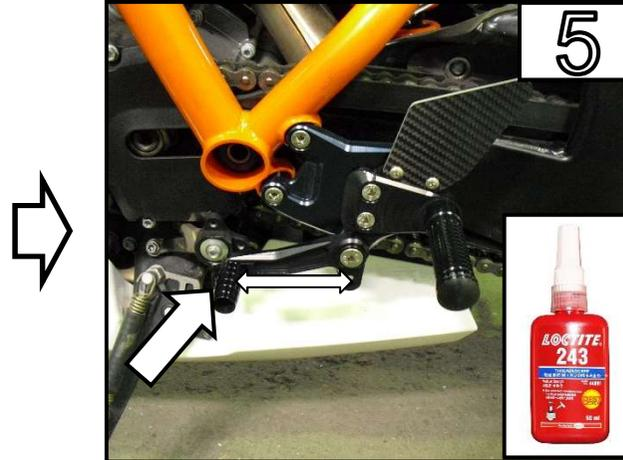
Schaltstange am Fahrzeug mit der originalen Schraube montieren und mit mittelfester Schraubensicherung z.B. Loctite 243 sichern.
