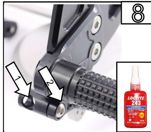
Durch Verdrehen der Kolbenstange die Bremshebelposition einstellen, danach mit der Schraube (Pfeil 2) und Schraubensicherungsmittel sichern
