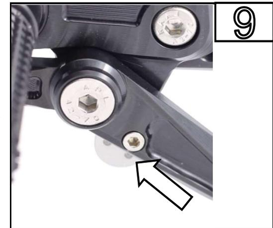
Durch Verdrehen und Festziehen der Exzentrerscheibe den Bremshebel gegen die Aufwärtsrichtung sichern
