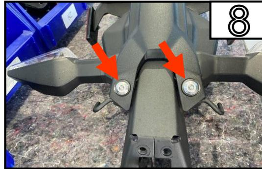
Entfernen Sie die 2 Schrauben.
