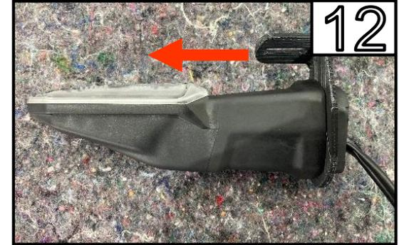
Montieren Sie den Blinker in der Halterung
