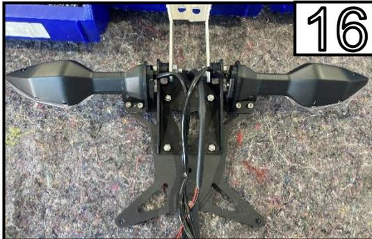
Montieren Sie die Blinkerhalter am Kennzeichenträger.
