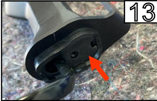
Montieren Sie die Metallplatte wieder im Blinker.
