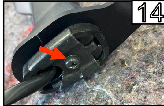
Befestigen Sie das Sicherungsblech wieder am Blinker mit der Schraube.
