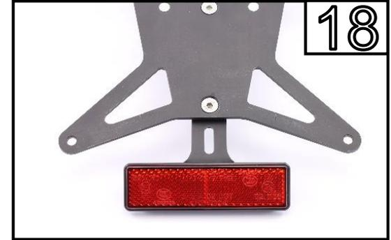
Montieren Sie den beigelegten Reflektor am MG Biketec Kennzeichenträger.
