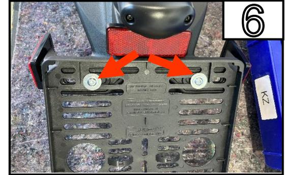
Entfernen Sie die 2 Schrauben.
