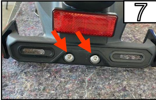
Entfernen Sie die 2 Schrauben.
