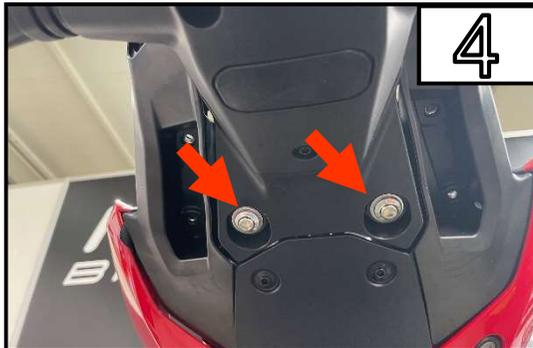
Entfernen Sie die Schrauben
