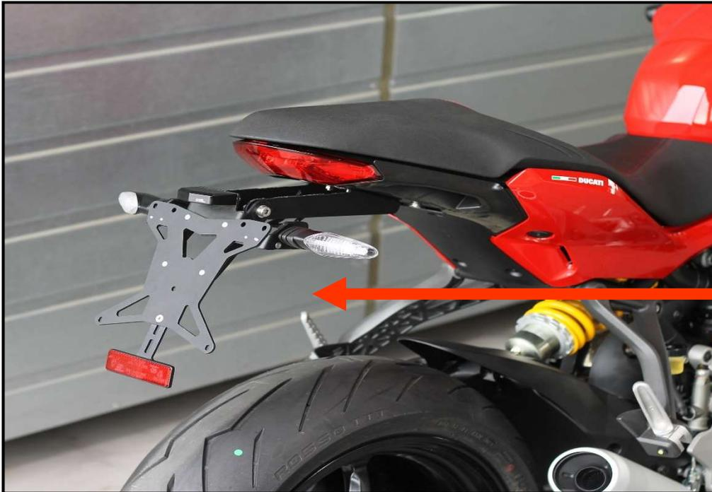
**DE: ACHTUNG:** Montieren Sie nur Ihr Nummerntafel – verwenden Sie keine zusätzliche Stahl- oder Aluminium-Trägerplatte – dies kann zu Bruchschäden an der Halterung führen!!
