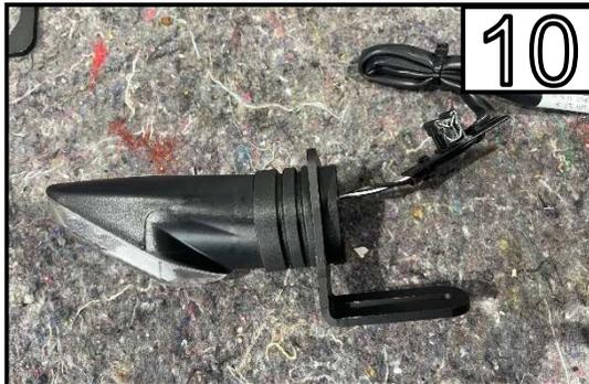
Führen Sie den Blinker in die Halterung
