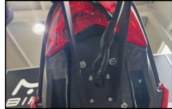
Montieren Sie den Kennzeichenträger mit den restlichen 2 Schrauben.
