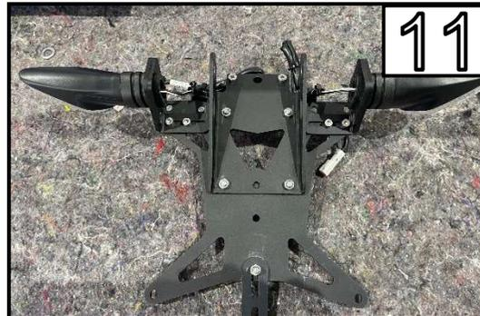
Montieren Sie die Blinker mit der Halterung mit
