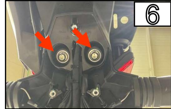
Entfernen Sie die Schrauben
