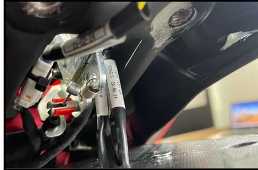
Führen Sie die Kabel der Blinker und Kennzeichenbeleuchtung rechts vorbei.
