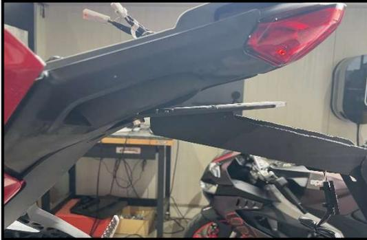
Montieren Sie den MG Biketec Kennzeichenträger mit den unteren 2 Schrauben.
