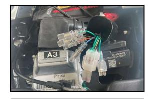
Trennen sie den Stecker der beiden Blinkerkabel und das für die Kennzeichenbeleuchtung Disconnect the plugs of both indicator cables and the one for the license plate light
