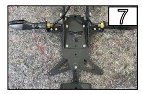
Montieren Sie die Blinker mit der Halterung mit den M4 Schrauben und den Bike Adapter am Kennzeichen
