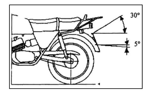
Richten Sie nun, den Kennzeichenträger so am Fahrzeug aus (Schraube A), dass er symmetrisch am Fahrzeugs sitzt und vom Winkel den gesetzlichen Anforderungen von 30° entspricht (siehe oberes Bild).
