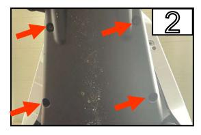
Entfernen Sie die 4 Schrauben und die Abdeckung
