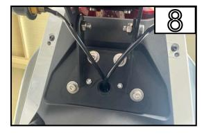
Führen Sie die Kabel durch den Ausschnitt und die Kabel in die Aussparung
