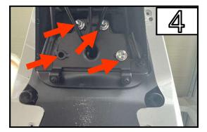
Entfernen Sie die 4 Schrauben und den Kennzeichenträger Remove all 4 bolts and the license plate holder
