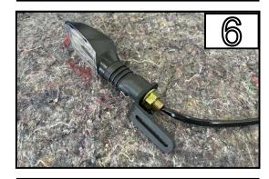
Führen Sie den Blinker in die Halterung und verschrauben Sie diesen mit der originalen Mutter
