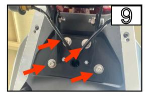
Verschrauben Sie den MG Biketec Kennzeichenträger mit den mitgelieferten Schrauben.
