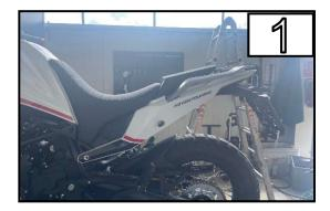
Entriegeln Sie die Sitzbank und entfernen Sie die Sitzbank *Unlock the seat and remove it*
