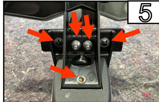
Entfernen Sie die 5 Schrauben.
