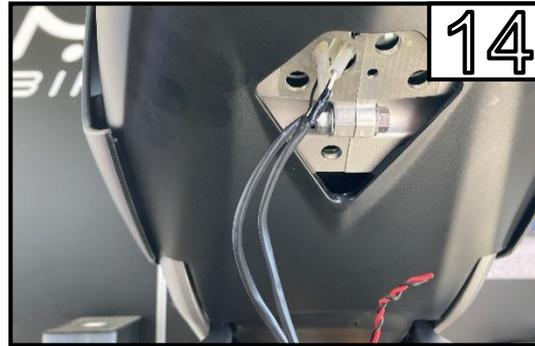
Kabel durch die Kabeldurchführung am Motorrad führen.
