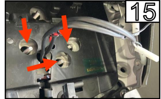
MG Kennzeichenträger mit den mitgelieferten M6 Schrauben befestigen.
