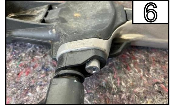
Entfernen Sie die Schraube am beide Blinker.
