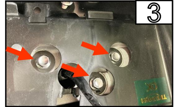
Entfernen Sie die 3 Schrauben.
