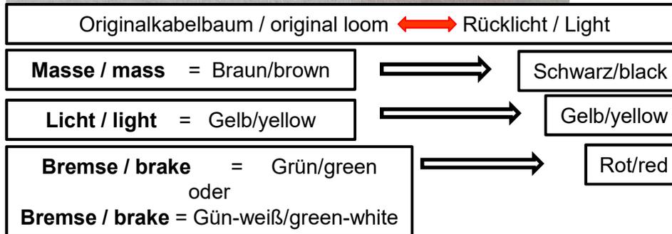
Zum Anschluss der Kennzeichenbeleuchtung verwenden Sie beiliegende Quetschverbinder.
