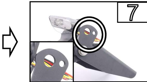
Führen Sie den original Blinker bei den beiden vorgesehenen Bohrungen ein und fixieren Sie diese mit der originalen Mutter /
