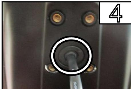
Entfernen Sie den Kennzeichenträger und entfernen Sie die Gummidichtung um anschließend das Kabel zu entfernen /
