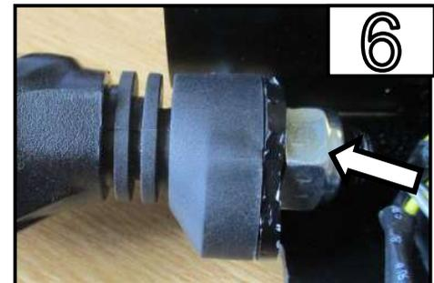
Entferne Sie die Mutter vom Blinker und entfernen den Blinker anschließend /
