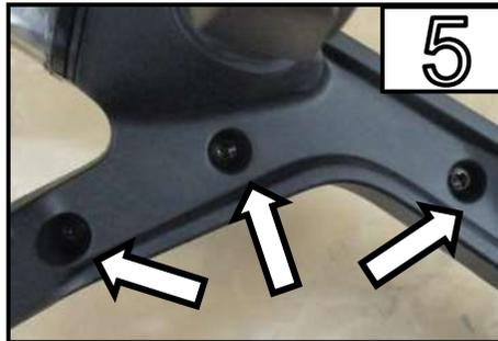
Entfernen Sie alle 3 Schrauben am Kennzeichenträger und teilen Sie diesen /
