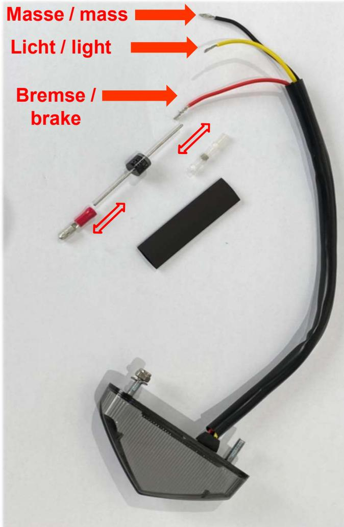
Zum Anschluss der Kennzeichenbeleuchtung mit Tempomat verwenden Sie beiliegenden Quetschverbinder, Diode, Lötverbinder und den Schrumpfschlauch.
